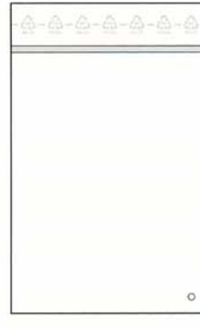
Gelocht Entweichung der Luft nach Befüllung
